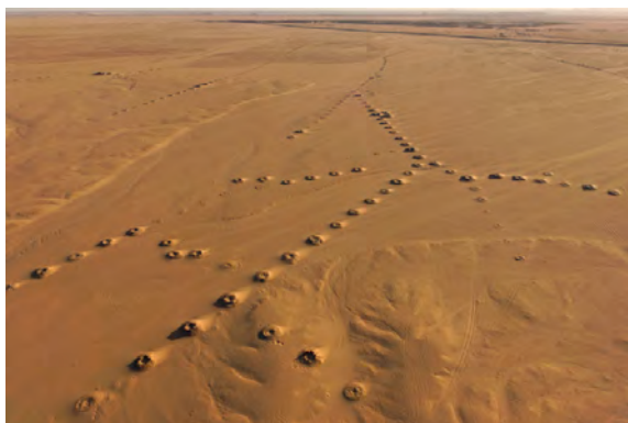
Photo 5.a. Vue aérienne des regards d'entretien d'une foggara, N.O Timimoune, Georges Steinmetz, 2007
